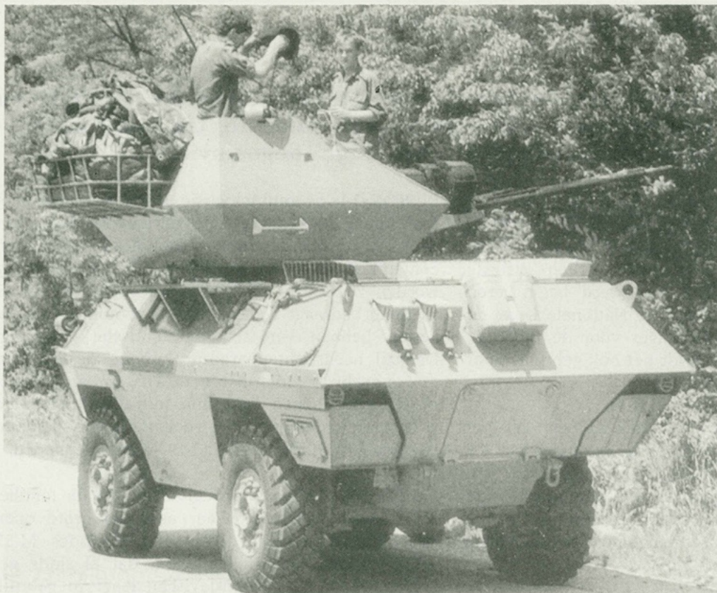
Helemaal onder: een BOV-M van de Joegoslavische militaire politie. Door de zwakke pantsering is de BOV tegen geen enkel anti-tankwapen bestand. Let op de schermen die naast de voorwielen zijn aangebracht.
